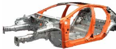
自動車骨格におけるホットスタンピング部材の適用部位
