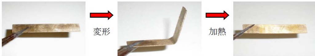
Cu-20wt%Zn-6wt%Al 曲げ試験
