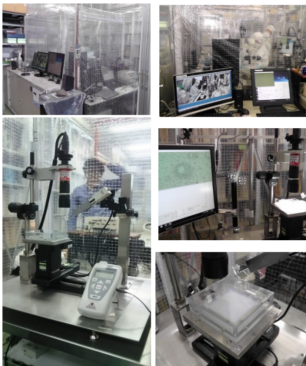
図4: 捕獲微粒子位置同定・観察・抽出システム(CLOXS)を設置した、LABAMたんぼぼクリーンルームの内側と外側の様子。
